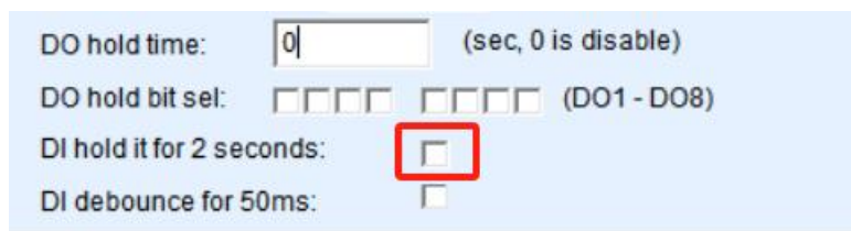
Figure 13 DI hold for 2 seconds function
